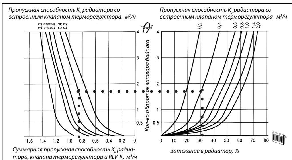
Заводская установка RLV-K предназначена для работы в двухтрубной системе отопления. Это означает, что встроенный байпас клапана закрыт.
